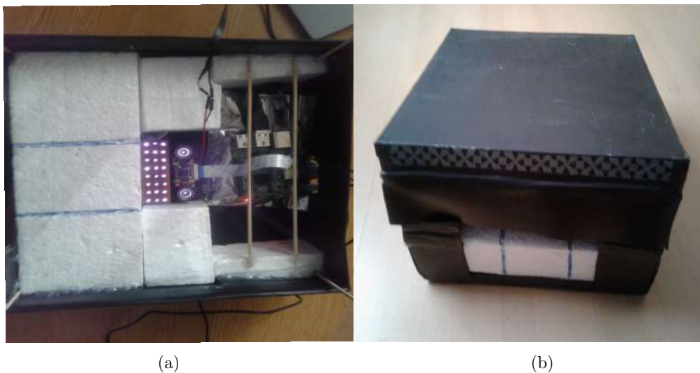
Figura 4.4: Primer diseño de la estructura externa del sistema de reconocimiento de patrones biométricos: (a) Vista interior y (b) Vista exterior.
