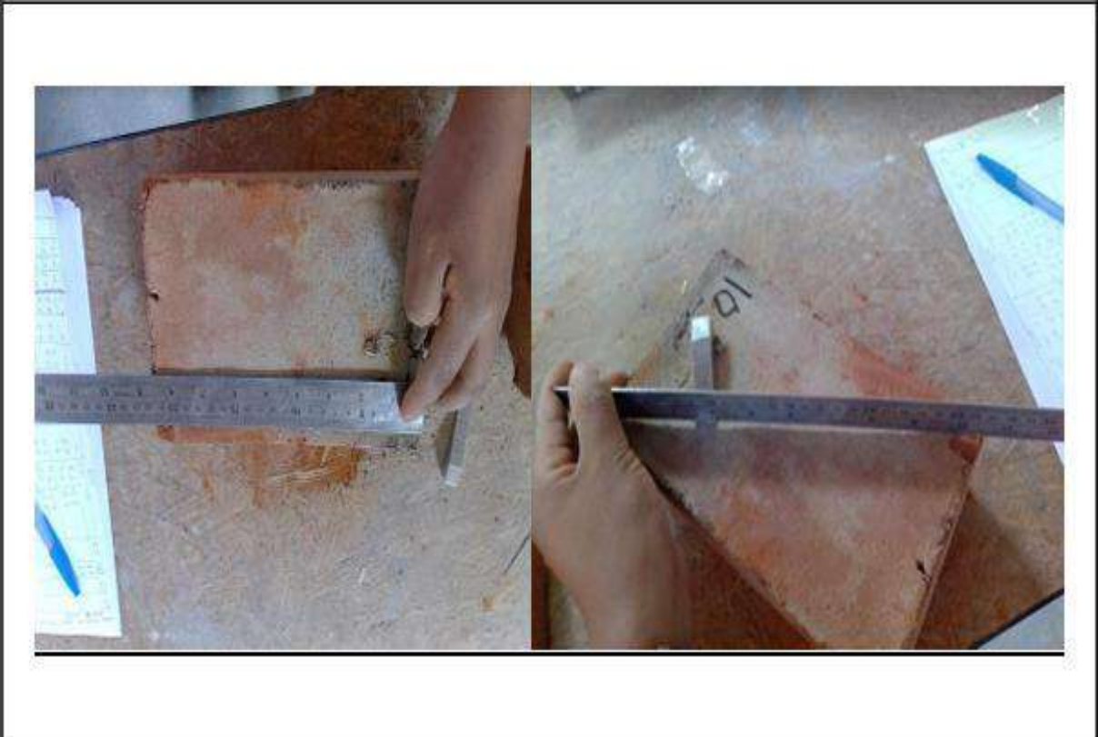
DESCRIPCIÓN: Se realizó los ensayos de variación dimensional y alabeo a muestra representativas según la norma NTP 399.613.
