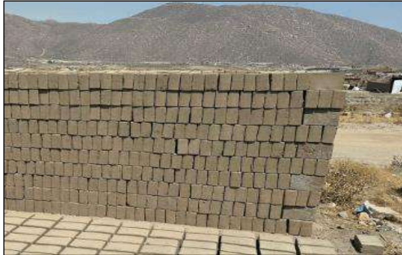
Figura 21. Secado final del ladrillo crudo
