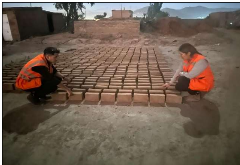
Figura 20. Pre secado del ladrillo crudo
