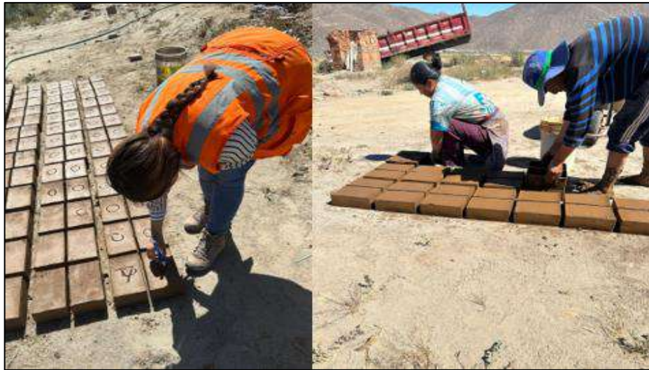
Figura 19. Moldeo de la mezcla
