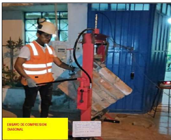
Figura 29. Ensayo de compresión diagonal
