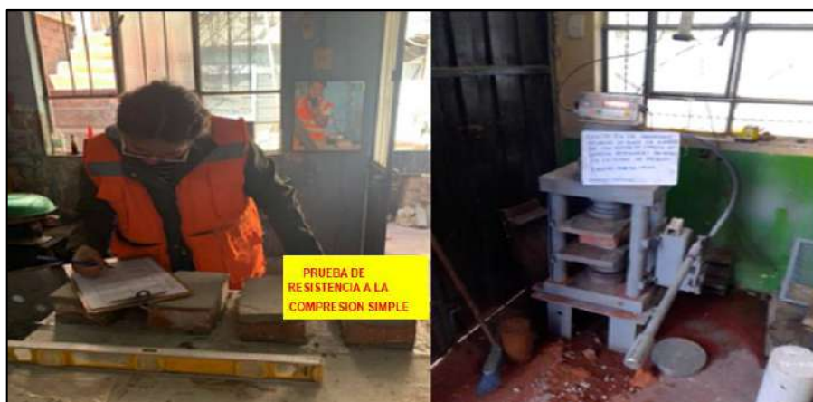
Figura 27. Prueba de resistencia a la compresión
