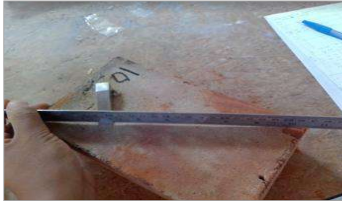
Figura 25. Ensayo de alabeo
