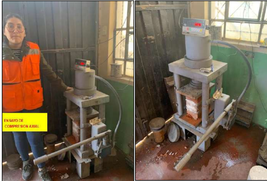
Figura 31. Ensayo de compresión axial
