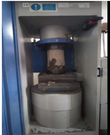
Figura 50. Rotura de testigos
