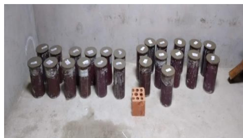
Figura 48. Testigos de concreto
