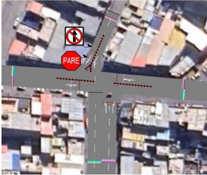
Figura 76. Distribución de tachones reflectivos y señal restrictiva.
