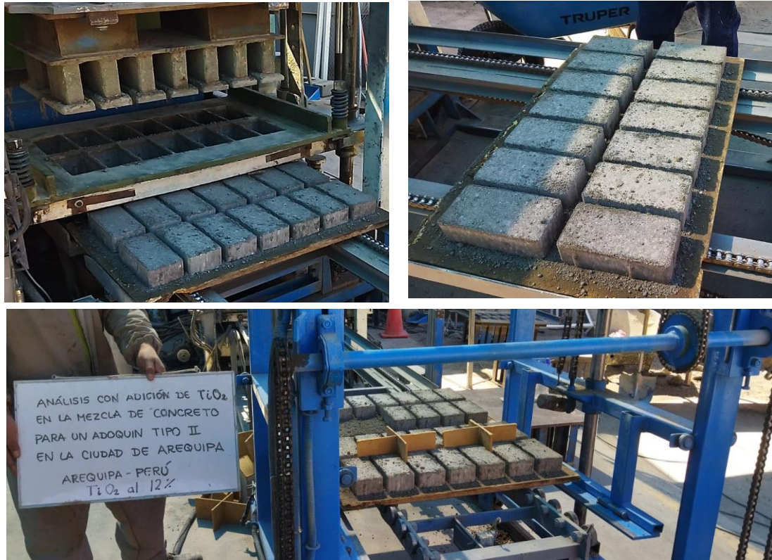
Figura 7: Proceso de vibro compactación de los adoquines. Fuente: Elaboración propia.
