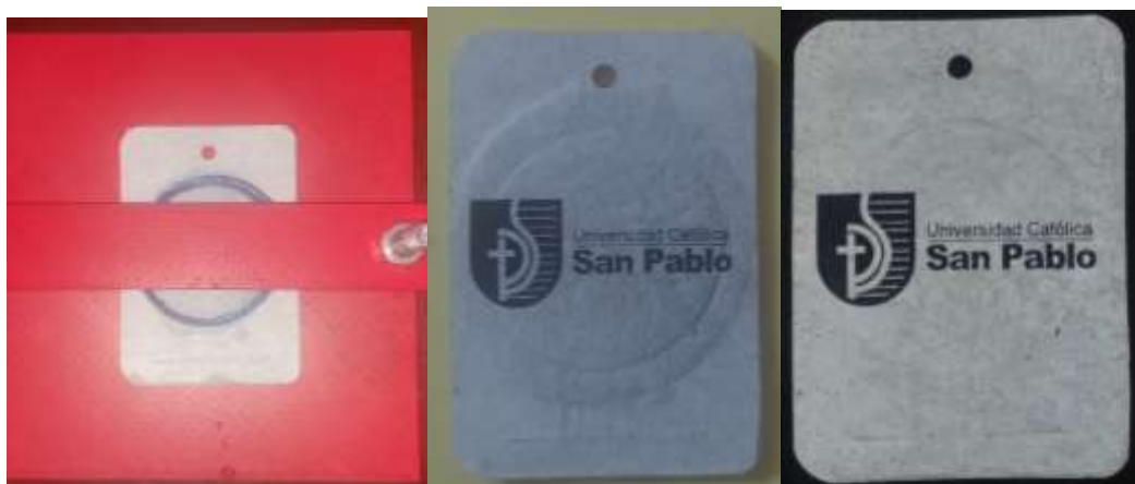
Figura 30: Prueba cobb de ecoetiqueta
